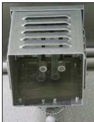
Illustration 2 : Boîte équipée de tubes passifs pour le prélèvement de benzène et de NO 2
